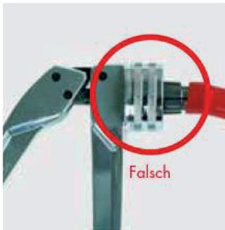
Aufweiten unter Biegespannung
