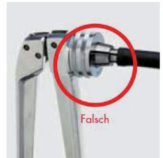
Rohr **nicht** vollständig auf Aufweitkopf aufgesteckt
