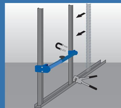
Der RasterMaster wird in das erste CW-Profil der Reihe mit Magneten „eingecлипst“. Das nächste CW-Profil heranschieben, bis dieses automatisch im gewünschten Abstand fixiert wird. Dann mit der Profil-Verbundzange die Profile verbinden.
