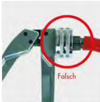
Aufweiten unter Biegespannung
