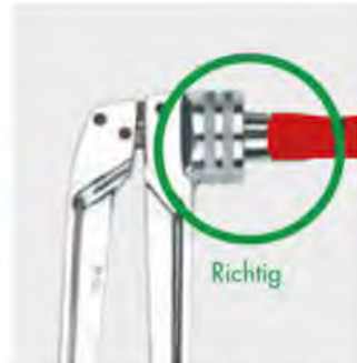
Rohr vollständig auf Aufweitkopf aufgesteckt
